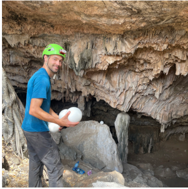
Kim commence l'installation de ses boules pour faire le scann 3D de la cavité. PhotoCBX
