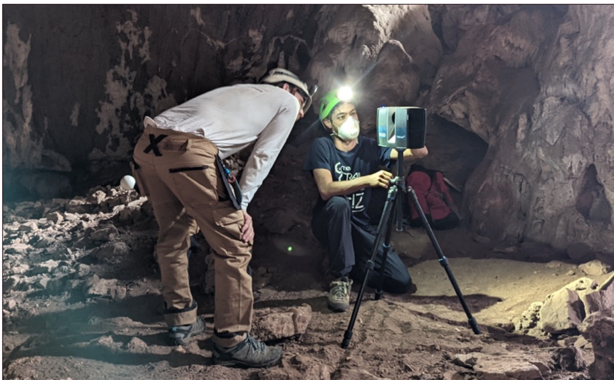
Figure 1. Acquisition topographique 3D dans des grottes. Ce projet a été rendu possible par le déploiement d'un scanner laser terrestre, en collaboration avec l'université Rouen-Normandie (UMR IDEES). Photo CBX
