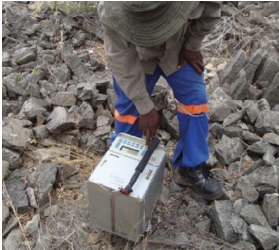
Le gravimètre est déplacé régulièrement pour la réalisation des mesures. Photo Poseidon Geophysics (FB Independent Cave explorers)
