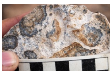
Fig.2 : lorsqu'on casse les brèches au marteau, on constate que les éléments qui les composent sont minéralisés et altérés. Ce qui indique que les processus à l'origine de leur formation ont été intenses. Photo BCH
