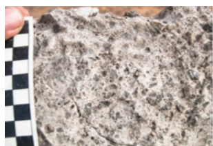
Fig.3 : au-dessus des brèches on trouve un calcaire coquillier, ce sont les calcrètes 4 de Cooke. Photo BCH.
