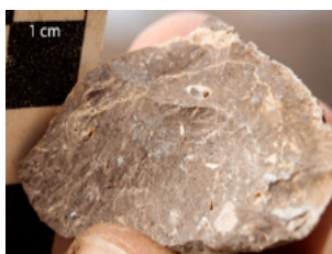
Fig. 6 : lorsqu'on casse le bloc, on observe un ciment calcaire sombre, riche en matière organique et en petits bivalves. Photo BCH.
