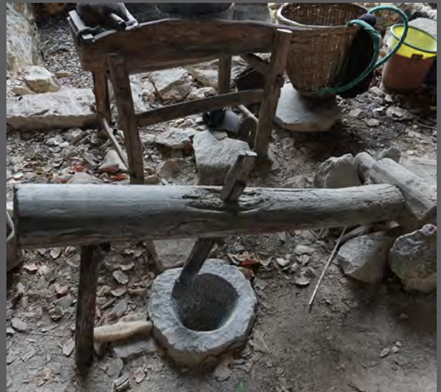
8. Décortiqueuse mécanique à levier pour le riz.
